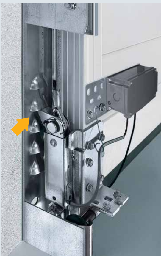
Запорный крюк устройства, предохраняющего от подваживания, надежно фиксируется автоматически.
