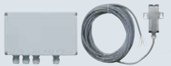
2-канальный релейный приемник HER 2 С 2 беспотенциальными релейными выходами, частота: 868 МГц, IP 65, рабочее напряжение 24 В пост. тока или 230-240 В перем. тока, отдельная антенна для наружного использования (IP 65), в защищенном от умышленного повреждения алюминиевом корпусе, с трехжильным соединительным проводом длиной 7 м, блок обработки сигналов для использования внутри помещения
