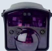
Радарный датчик движения Komfort Радарный датчик движения и присутствия – опознавание по инфракрасному излучению. Быстрое целенаправленное автоматическое открывание ворот. Надежная защита зоны подхода. Для ворот высотой до 6 м. Снаружи и при высокой влажности воздуха работает только радарный датчик. Корпус: степень защиты IP 65.
