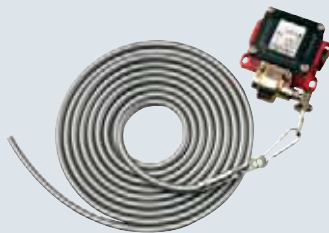
Выключатель с тяговым шнурком, с пластмассовым тросиком Возможен монтаж в вертикальном или горизонтальном положении, отлитый под давлением алюминиевый корпус, IP 65, длина тросика 4 м.
